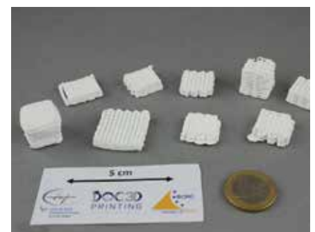
Photo de pièces macroporeuses en phosphate de calcium par robocasting
